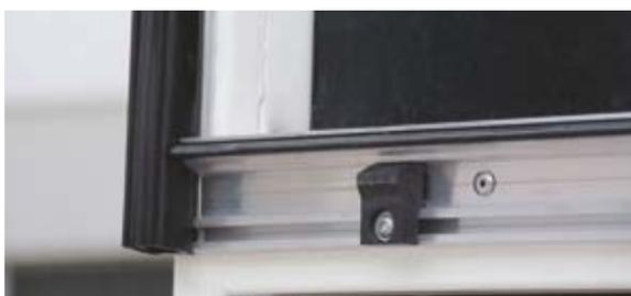
Système d'étanchéité **CargoSeal** (en option pour S2 et S4) pour bordure arrière fiable dans le cas de carrosseries avec refroidissement à l'azote sans portes.
