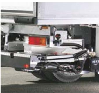
**Plate-forme PBret/PBhyd** avec partie fixe et partie mobile en aluminium.
