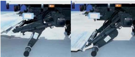
Barre **anti-encastrement mécanique** de série pour BC 2000 S4U. Est maintenue au sol par le pied pour être rabattue en fonctionnement solo du camion ou être relevée lors de l'utilisation de l'attelage normal.
