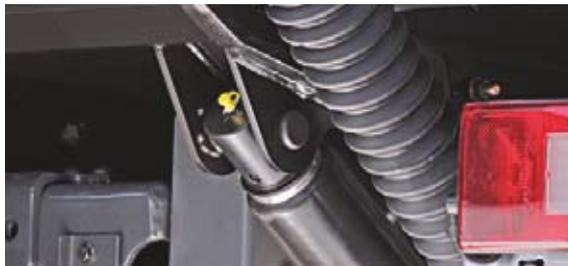
Vérin hydraulique avec **gaine de protection** ou **soufflet de vérin** en tant que protection contre les gravillons et la corrosion. Ouverture motorisée et rapide de façon régulière grâce à un **vérin d'inclinaison à double action**, même en hiver.
