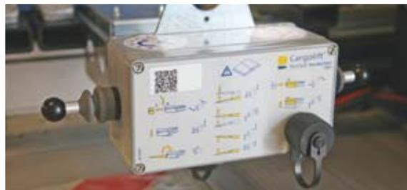
Le boîtier de commande Bär avec commutateur à clé empêche l'utilisation non souhaitée du Cargolift sur une remorque, semi-remorque. De série sur S4A, R2T et R4T.
