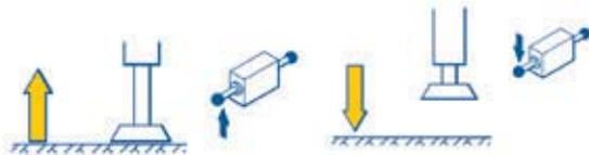
Des remorques à essieux centraux dételées sont bloquées au niveau du timon et de l'arrière par des **béquilles hydrauliques**. Les béquilles sont manœuvrables séparément, simultanément ou automatiquement depuis la carte eBC du hayon.
