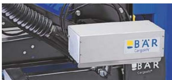
Dans les régions soumises à de fortes intempéries, le boîtier de commande Bär est protégé en outre par un boîtier de protection en acier inoxydable en option.
