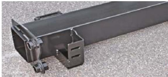
**Protection par cataphorèse** (coloris RAL 9005) de toutes les pièces en acier en tant que protection anticorrosion à long terme sans peinture supplémentaire. En cas de nettoyage fréquent des véhicules, **revêtement de protection par cataphorèse + poudre** dans le coloris souhaité en option.
