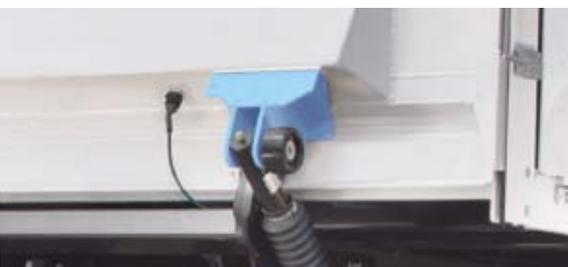
**Galets de roulement** en tant que protection de la plateforme contre les éraflures lors du contact avec le sol.
