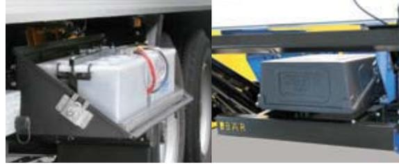
Alimentation électrique fiable avec le **boîtier de batterie Bär**, montée de façon compacte sur la barre anti-encastrement. Également disponible en tant que **Bär BatteryBox** pour être montée latéralement sous la carrosserie.
