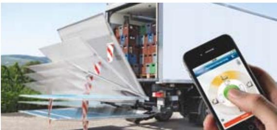
**Bär SmartControl Bluetooth** : la commande innovante de Cargolift L'équipement en option **SmartPackage** et la **Bär CargoApp** permettent de commander le Cargolift via iPhone. La perte de commandes à distance est reléguée au passé.
