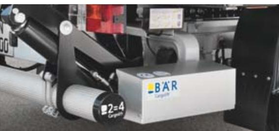
Avec le BC 750 A2L/S2 et le BC 2000 S4U/R4U : Groupe et commande faciles d'entretien et protégés dans le **boîtier latéral en aluminium**.
