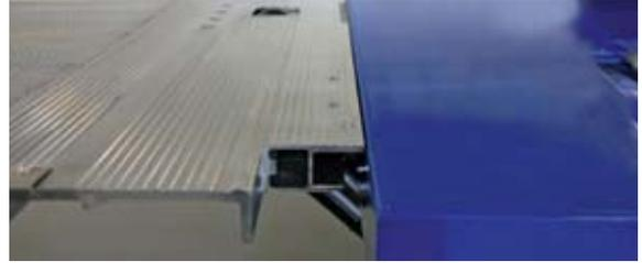
Les Cargolifts RetFalt disposent de série d'un **pont dur** en aluminium. Vous bénéficiez d'une connexion qui restera impeccable sur le long terme entre la carrosserie et Cargolift.
