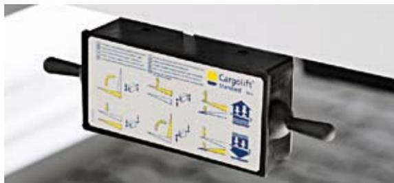
Grâce au commutateur à levier, le boîtier de commande Bär dispose d'une utilisation très intuitive. De série sur Cargolift Bär standard S2 et A2L.
