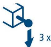
Wird der rechte Bedienhebel drei Mal nach unten betätigt, so werden die **Blinkleuchten** bei geöffneter Plattform **ausgeschaltet**, zum Beispiel beim Einsatz an der Rampe.
