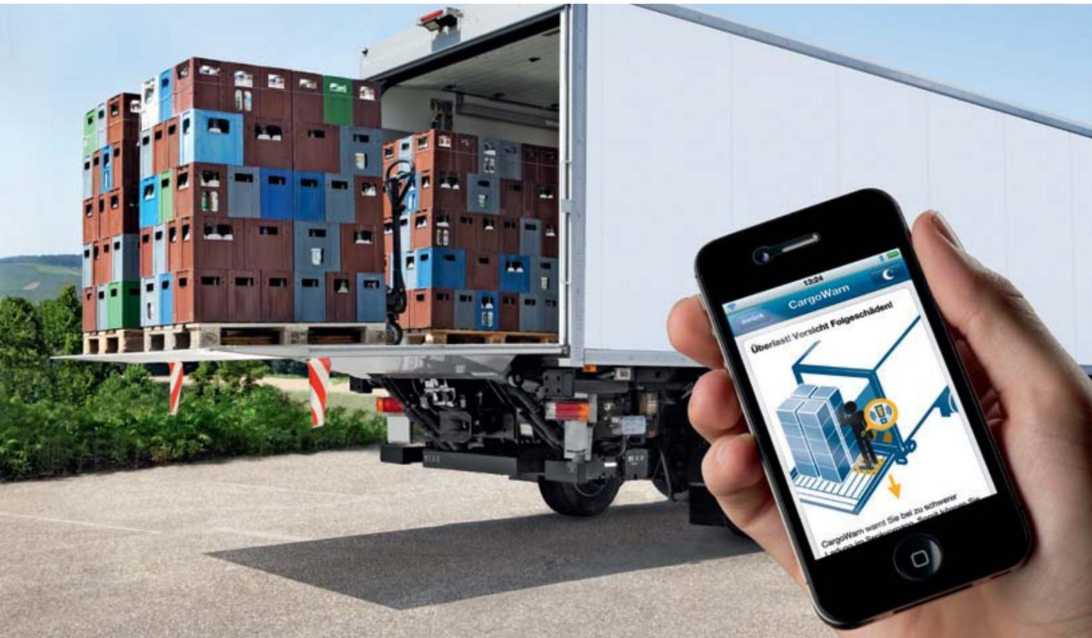
Eine lange gehegte Forderung der Fuhrparkleiter wird zur Weltneuheit bei Bär Cargolift: die Überlastanzeige CargoWarn. Als optionale Überlast-Prüffunktion beim Abladen mit einem Bär Cargolift Standard S4 reduziert CargoWarn die Unfallgefahr durch Signalisierung bei Überlast. Dies steigert die Langlebigkeit des Bär Cargolift durch Fahrerqualifikation im Hubladebühnen-Einsatz.
