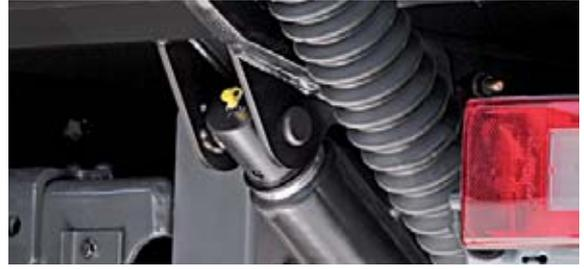
Hydraulikzylinder mit **Schutzrohr** oder **Faltenbalg** als Schutz vor Steinschlag und Korrosion. Gleichmäßig schnelles, motorisches Öffnen durch **doppelt wirkende Neigzylinder** – selbst im Winter.
