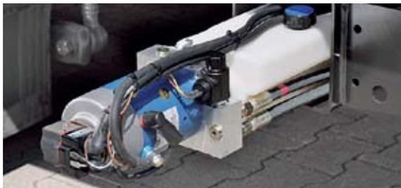
Sicher geschützt, das **Aggregat** im Tragrohr. Motor mit Thermoschutzschalter. Optional als **Leiselaufaggregat** oder als **3kW-Aggregat** verfügbar.
