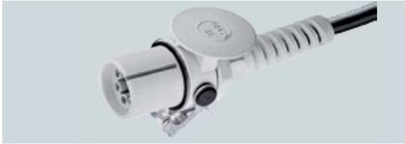
Elektronisch gesteuerte Ladeleitung **SmartCharge SC-VEHH** als genormte Steckverbindung zum beliebigen Tausch von Zugfahrzeug und Anhänger. Intelligente Steuerung sichert ausreichende Batteriespannung an der Abladestelle. Anzeige von Störungen per Blinksignal.
