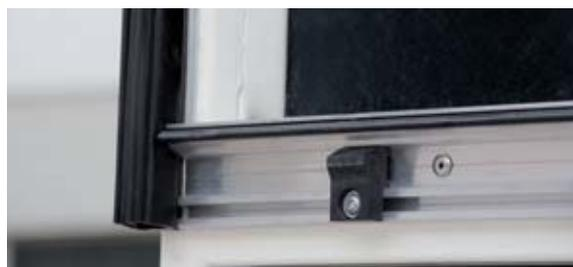
Dichtsystem **CargoSeal** (optional) für zuverlässigen Heckabschluss bei Aufbauten mit Stickstoffkühlung ohne Türen.
