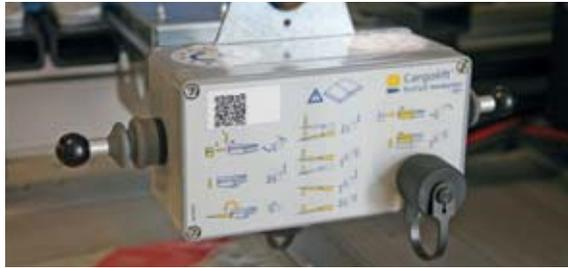
**Bär Bedieneinheit mit Schlüsselschalter** verhindert ungewünschte Bedienung des Cargolifts am Anhänger, Sattelaufleger.
