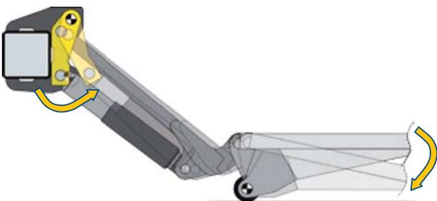
Sanftes Aufsetzen durch **automatisches Abneigen am Boden** für sicheres Verladen. Per MemoryEffekt geht die Plattform beim Aufneigen in ihre ursprüngliche Position.
