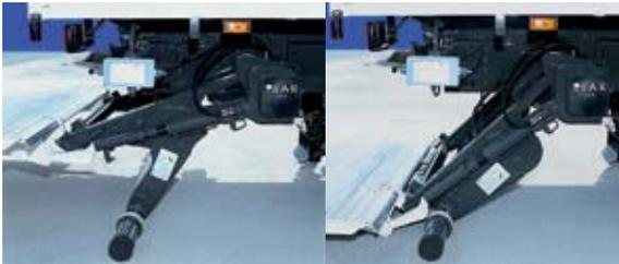
Serienmäßig **mechanischer Unterfahrerschutz** für BC 2000 S4U. Wird zum Abklappen bei Lkw-Solo-Fahrbetrieb oder bei Nutzung der Normalkupplung beim Hochfahren mit dem Fuß am Boden festgehalten.
