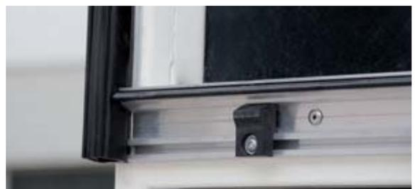
Dichtsystem **CargoSeal** (optional) für zuverlässigen Heckabschluss bei Aufbauten mit Stickstoffkühlung ohne Türen.
