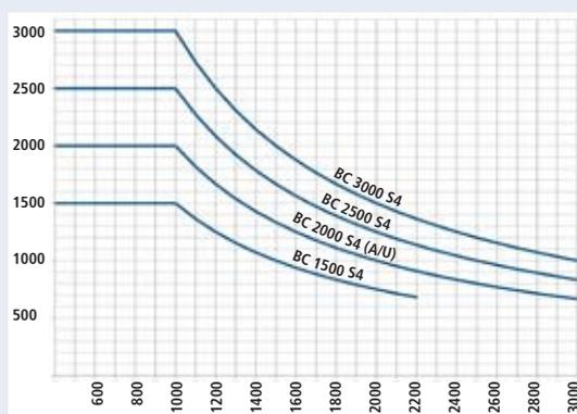
Wird der Lastabstand z. B. bei hoher Plattform verdoppelt, reduziert sich die Tragkraft um die Hälfte.
