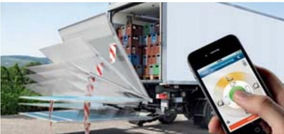
**Bär SmartControl** – Die innovative Cargolift-Bedienung. Mit der optionalen Ausstattung **SmartPackage** und der **Bär CargoApp** kann der Cargolift über das iPhone gesteuert werden. Verlorene Fernbedienungen gehören der Vergangenheit an.
