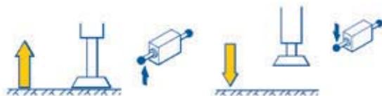
Abgekuppelte Zentralachsanhänger werden durch **hydraulische Stützen** an Deichsel und Heck arretiert. Stützen sind separat oder gleichzeitig ansteuerbar. Mit verstärktem Stützzyliner.
