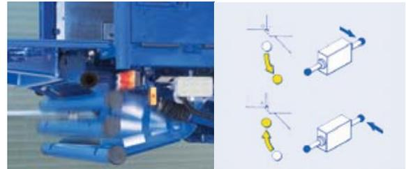
Optionaler **hydraulischer Unterfahrerschutz** für BC 2000 S4U ermöglicht die hydraulische Bedienung des Unterfahrerschutzes über die Bedieneinheit.
