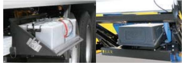
Zuverlässige Stromversorgung mit dem **Bär Batteriekasten** – kompakt auf Unterfahrerschutz montiert. Ebenfalls als **Bär BatteryBox** zur seitlichen Montage unter dem Aufbau verfügbar.
