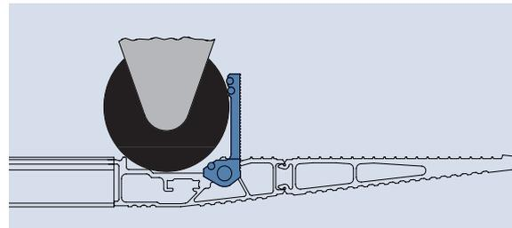
**Ax** als Mulde mit Öffnungswinkel 90° für Rollendurchmesser bis 200 mm. Klappen öffnen einzeln.
