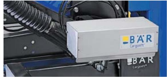
In Regionen mit starken Witterungseinflüssen kann die Bär Bedieneinheit zusätzlich mit einem optionalen **Schutzkasten** aus Edelstahl geschützt werden.
