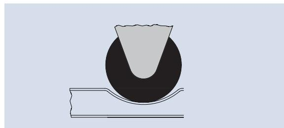
**Tellermulde** mit doppeltem Boden, dient der Sicherung eines quer gestellten Rollbehälters in Aufbau-Nähe.
