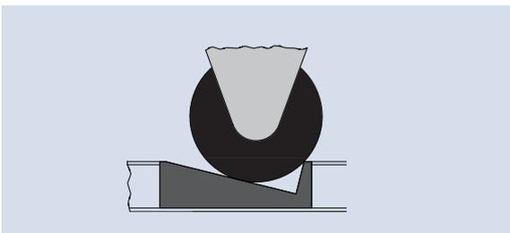
**Massivmulden** aus einem Stück gefräst, dienen der Sicherung von Rollbehältern in der Plattformspitze.
