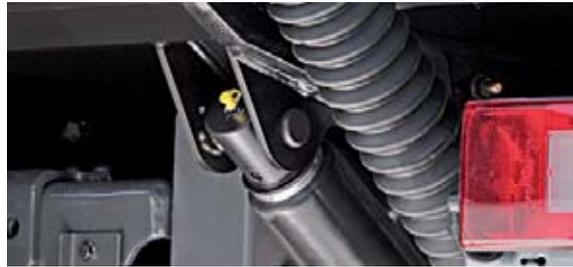
Hydraulikzylinder mit **Schutzrohr** oder **Faltenbalg** als Schutz vor Steinschlag und Korrosion. Gleichmäßig schnelles, motorisches Öffnen durch **doppelt wirkende Neigzylinder** – selbst im Winter.
