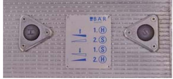
**Bär Fußsteuerung** bietet neben einem sicheren Standort eine einfache Bedienung über zwei Fußschalter.
