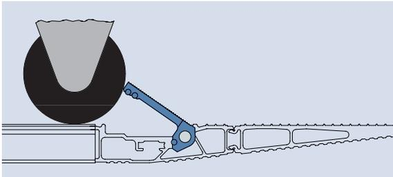
**Rx** als Barriere für die Rollen mit Öffnungswinkel 43° für Rollendurchmesser bis 110 mm. Klappen öffnen gleichzeitig.
