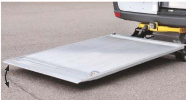
Sanftes Aufsetzen durch **automatisches Abneigen am Boden** (Serie) für sicheres Verladen.
