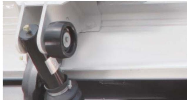
**Bodenrollen** (Serie) schützen die Plattform bei Bodenkontakt vor mechanischem Abrieb.
