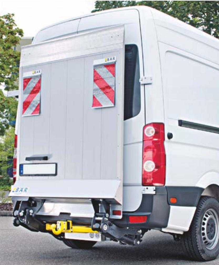
Mit der Tragkraft von 500 / 600 kg und der 1380 mm breiten Standard-Plattform unterstützt Sie dieser Bär VanLift optimal, wenn Sie häufig eine Entladehilfe benötigen – egal ob für Rollbehälter oder Palette. Mit minimalem Eigengewicht, schneller Montage ohne Karosseriearbeiten und Anhängerbetrieb mit Kugelkopfkupplung bietet Ihnen dieser Bär Cargolift viele Vorteile in der VanLift-Klasse.
