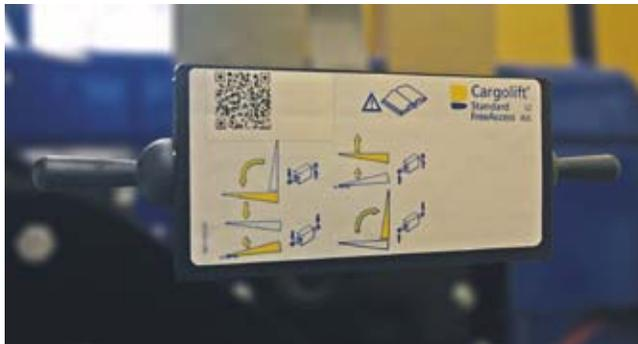
Bär **Steuerkasten** (Serie) zur Bedienung der vier Grundfunktionen des Cargolifts.
