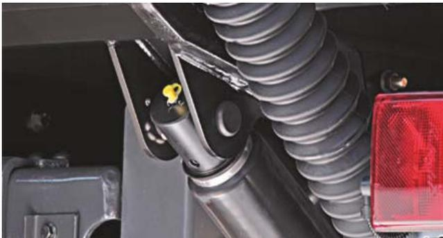
Hydraulikzylinder mit **Schutzrohr** oder **Faltenbalg** (Serie) als Schutz vor Steinschlag und Korrosion. Gleichmäßig schnelles, motorisches Öffnen durch doppelt wirkende Neigzylinder – selbst im Winter.
