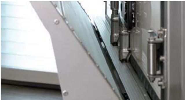
Bär **CargoBridge** (Option) für Anbau der Plattform hinter Koffertüren mit Drehstangenverschlüssen. Erspart aufbauseitige Überfahrnase.
