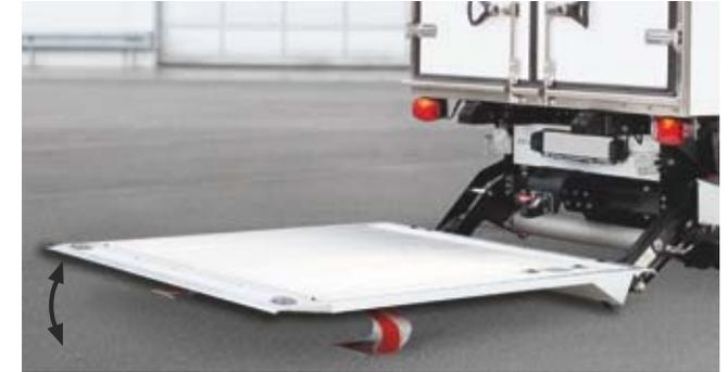
Sanftes Aufsetzen der Plattform durch **automatisches Abneigen am Boden** (Serie) für sicheres Verladen.
