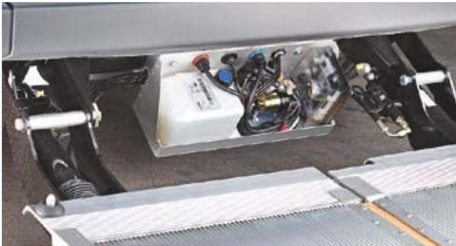
**KTL-Beschichtung** (RAL 9005 - Serie) aller Stahlteile als Langzeitkorrosionsschutz ohne zusätzlichen Decklack. **Aggregat-Gehäuse** schwenkt mit dem Lift ab, daher gute Zugänglichkeit für Service.
