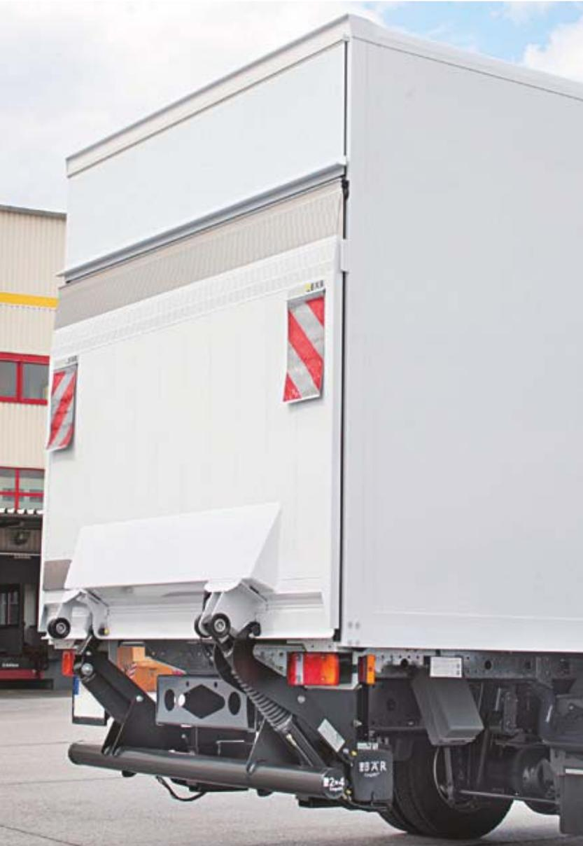
Das optimale Verhältnis von Eigengewicht und Stabilität mit nur einem Hub- und einem Neigzylinder findet sich beim BC 1500 S2. Denn dieser Cargolift der Produktgruppe Standard S2 verfügt über ein Lastmoment von 12,0 kNm und unterstützt damit Lkw ab 12,0 t Gesamtgewicht optimal in der täglichen Arbeit.
