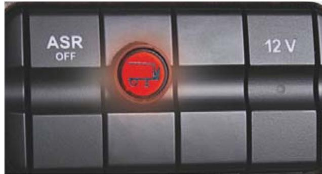
**Fahrerhauseinschaltung** mit Rückmeldesignal (Serie) gemäß EN 1756-1, sobald die Plattform geöffnet ist.
