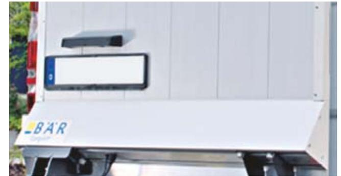
Vormontierter **Kennzeichenhalter mit Beleuchtung**. Plattformrückseite **Aluminium Natur** und Randabschlussprofil **eloxiert** (Serie).
