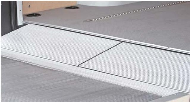
Zweigeteilte **VanBridge** (Serie) schafft einen nahtlosen Übergang zwischen Plattform und Ladeboden über ein unbelastetes Gummischarnier. Während der Fahrt per Magnet an der Hecktüre arretiert oder flach auf den Boden gelegt.
