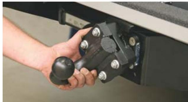
Abnehmbare **Kugelkopfkupplung** komplett mit Kugel (Option), Stützlast max. 120 kg, Gewicht ca. 30 kg. Elektrische Vorrüstung fahrerzeitig erforderlich! Anhängelast wie Original Kastenwagen. Nicht möglich bei Mercedes-Benz Sprinter mit Achsübersetzung AR1 und Schaltgetriebe.
