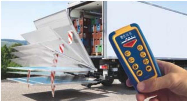
Bär **SmartControl Fernbedienung** (Option, vier Funktionen Funk) – Die zeitgemäße Cargolift-Bedienung per innovativer Funkfernbedienung. Mit **RadioKey** (Option) erfolgt eine automatische Sperrung gegen unbefugte Nutzung durch Nahbereichserkennung.
