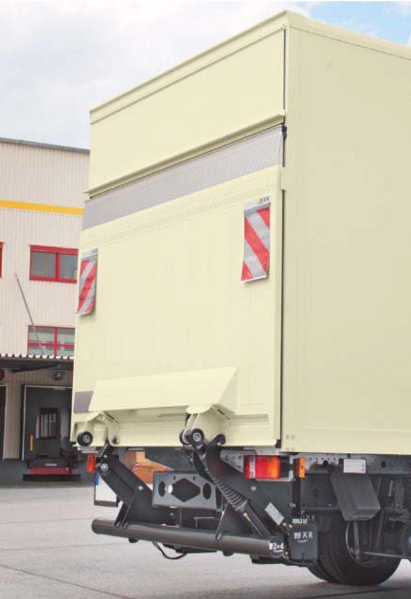
Dank des geringen Eigengewichts ab 291 kg sorgt der BC 1000 S2 für eine positive Nutzlastbilanz. Zwei Rollbehälter oder eine Palette mit Gabelhubwagen können einfach und schnell be- und entladen werden. Zudem ist dieser Cargolift im bekannten Maße servicefreundlich und wartungsarm.
