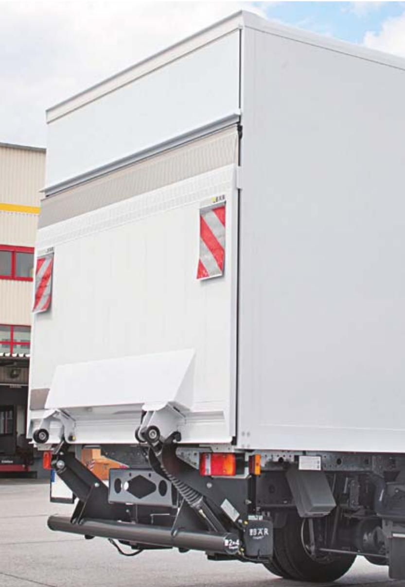
Fahrzeuge mit niederbauendem Rahmen lassen wenig Freiraum für einen mitfahrenden Unterschutz. Für diese Fahrzeuge ist der BC 1500 S2N konzipiert, denn er benötigt bei voll beladenem Fahrzeug nur 465 mm Bodenfreiheit und bietet mit 12,0 kNm ein erstaunlich hohes Lastmoment – vom Eigengewicht ganz zu schweigen.
