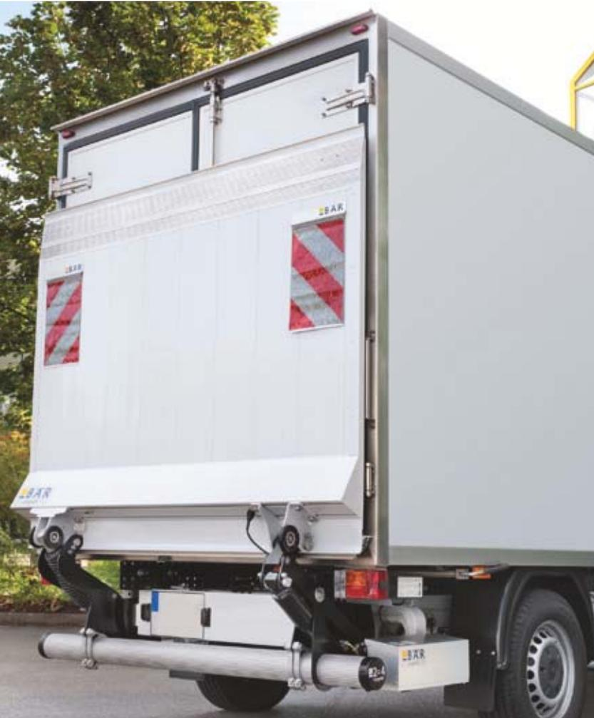
In der Klasse bis 750 kg Tragkraft ist der BC 750 S2 mit seinen 194 kg ein Maßstab für Eigengewicht und Stabilität. Erreicht werden diese durch die weitestgehende Verwendung von Aluminium im Plattformkonzept BAplan und durch hochfesten Stahl im Hubwerk. Er ist deshalb der geborene Cargolift für die Lkw-Klasse 3,5 t bis 6,5 t Gesamtgewicht.
