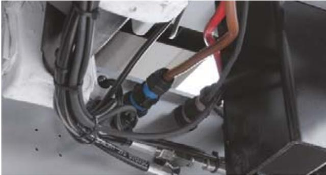
**Elektrische Schnittstelle VDHH** (Serie BC 750 S2) für den einfachen elektrischen Anschluss.
