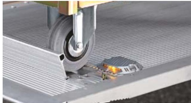
Zweigeteilte **Abrollversicherung 2ad** (Serie) für zwei Rollbehälter. Versenkte, leicht überfahrbare **CargoFlash**-Blinkleuchten (Serie) mit LED-Technik.
