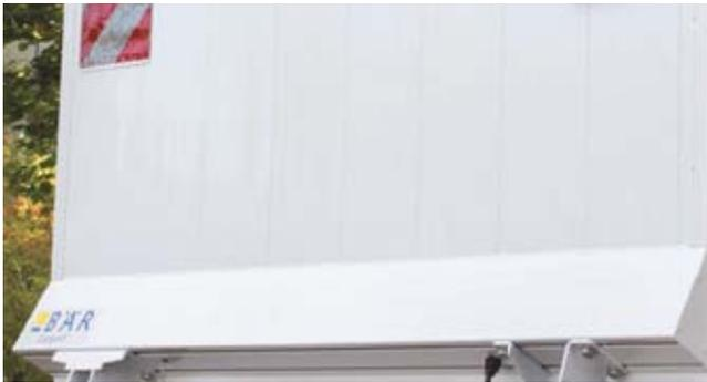
Plattformrückseite **Aluminium** natur (Serie) oder **pulverbeschichtet** in Wunsch-RAL-Farbtönen (Option) sowie **eloxierte** Plattform (Option) möglich.
