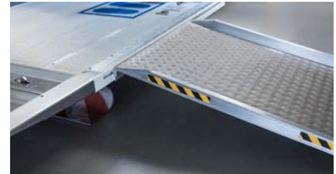
**Randabschlussprofil** (Option) zum stufenlosen Einhängen einer seitlichen **Verladeschiene** (Option) verfügbar ohne Spurführung (Länge 1000 mm; Breite wahlweise 600 / 734 / 845 mm).
