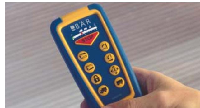
La **télécommande SmartControl** (série) remplace le montage de boutons de commande dans la carrosserie. Quatre fonctions radio avec détection de proximité.
