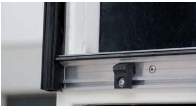
Système d'étanchéité **CargoSeal** (option) pour une fermeture étanche par la plateforme sur l'arrière de la caisse.
