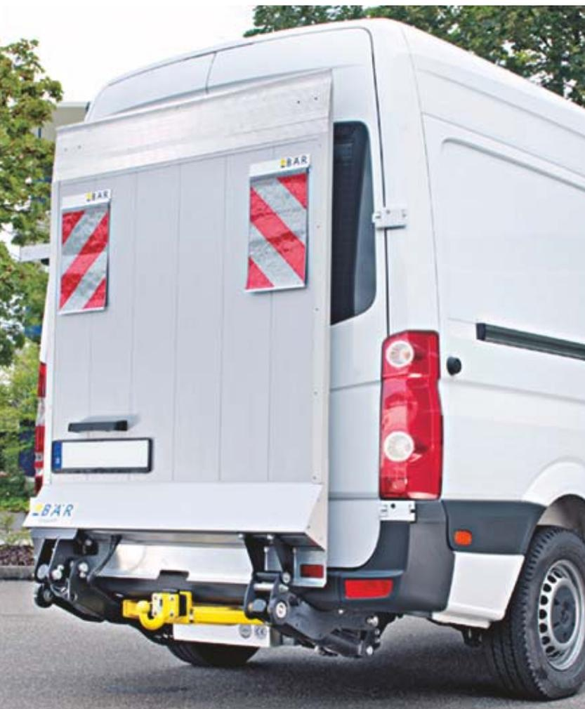
Avec une capacité de charge de 500/600 kg et la plateforme Standard de 1380 mm de large, ce Bär VanLift est un outil optimal si vous avez régulièrement besoin d'un auxiliaire de déchargement, que ce soit pour des rolls conteneurs ou des palettes. Avec un poids propre minimal, un montage rapide sans travaux de carrosserie et l'utilisation avec remorque et attache à boule, ce Cargolift de Bär vous fournit tous les atouts de la classe VanLift.
