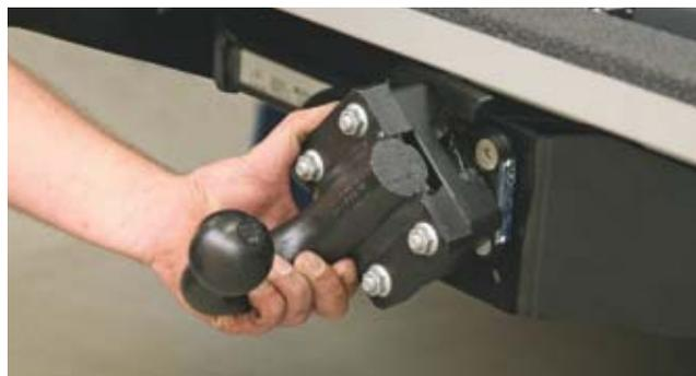
**Attelage à boule** amovible complète avec boule (option), charge d'appui max. 120 kg, poids env. 30 kg. Pré-équipement électrique du côté véhicule requis ! Charge remorquée comme fourgon d'origine. Pas possible sur les Sprinter Mercedes-Benz avec rapport de pont AR1 et boîte de vitesses.
