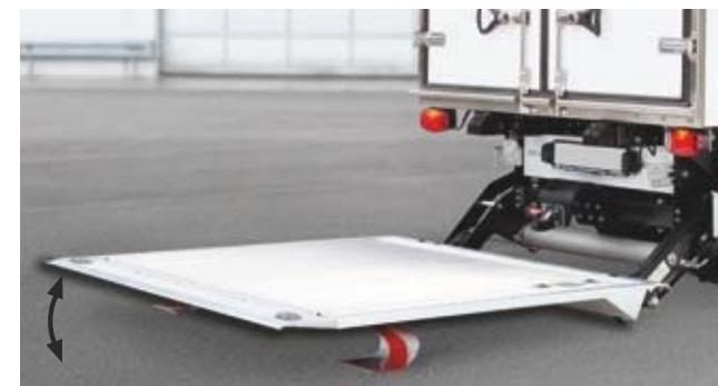
Dépose en douceur de la plateforme grâce à un **abaissement automatique** sur le sol (série) pour un chargement en toute sécurité.
