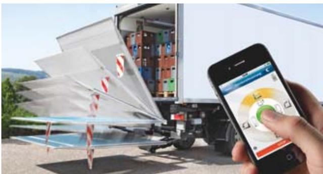
Bär **SmartControl Bluetooth** (option) – la commande innovatrice pour Cargolift. L'équipement en option SmartPackage et la Bär CargoApp permettent de commander le Cargolift via iPhone. La perte de télécommandes est reléguée au passé.
