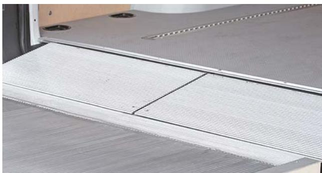
**VanBridge** en deux parties (série) crée un passage continu entre la plateforme et le seuil de chargement par une charnière en caoutchouc. Pendant le roulage, bloqué par un aimans sur la porte arrière ou posé à plat sur le plancher.
