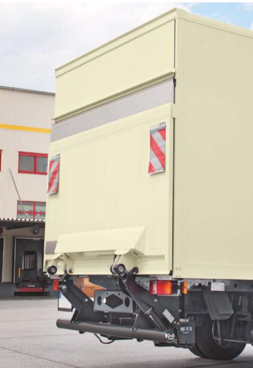
Grâce au faible poids propre à partir de 291 kg, le BC 1000 S2 s'avère positif dans le bilan de la charge utile. Un transpalette peut charger et décharger aisément et rapidement deux rolls conteneurs ou une palette. En outre, ce Cargolift est fidèle à sa réputation de service aisé et entretien réduit.
