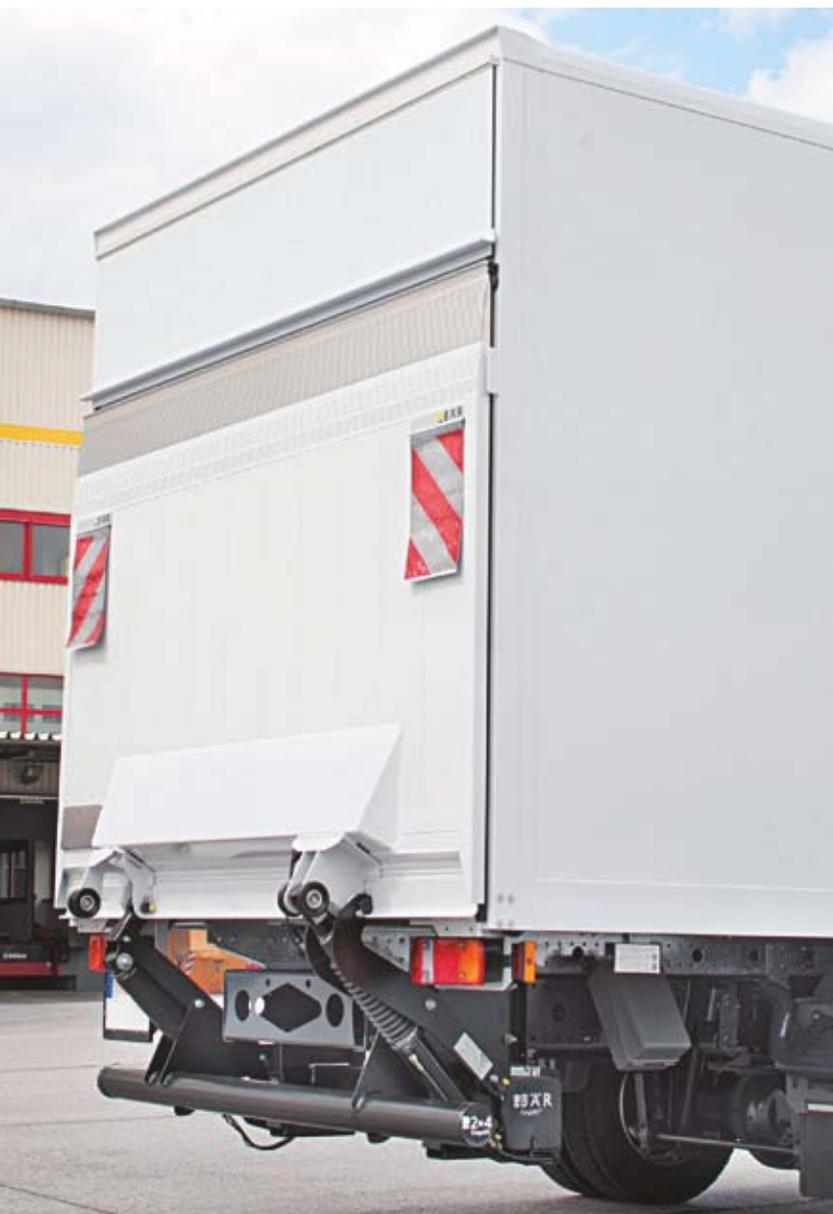
Le BC 1500 S2 réunit le rapport optimal entre poids propre et stabilité avec seulement un vérin de levage et un vérin d'inclinaison. En effet, ce Cargolift du groupe de produits Standard S2 présente un moment de torsion de la charge de 12,0 kNm et pour les camions à partir de 12,0 t, il s'avère être une aide optimale pour les opérations au quotidien.
