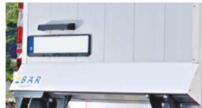
Support de **plaque d'immatriculation monté avec éclairage**. Dos de la plateforme revêtu par poudre en **aluminium naturel**. Profil de bord **anodisé** (série).
