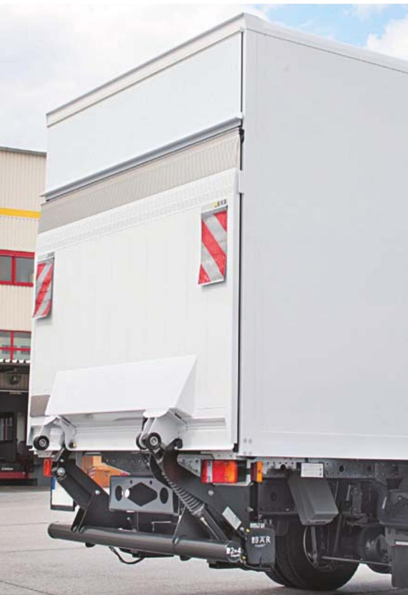
Des véhicules avec châssis bas laissent peu d'espace libre pour une barre anti-encastrement. C'est précisément pour ces véhicules qu'est conçu le BC 1500 S2N car sa garde au sol requise en cas de plein chargement du véhicule n'est que de 465 mm et il présente un moment de torsion de la charge incroyablement élevé de 12,0 kNm, sans mentionner son propre poids.
