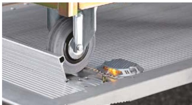
**Bloqueur de roll** en deux parties **2ad** (série) pour deux rolls conteneurs. Feux de plateforme **CargoFlash** moulés, facilement franchissables (série) avec technique LED.
