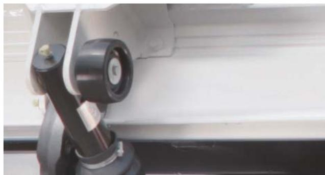
Des **galets de roulement** (série) protègent la plateforme lors de son contact avec le sol contre les détériorations.
