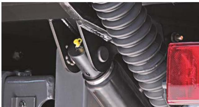
Vérin hydraulique avec **gaine de protection** ou **soufflet de vérin** (série) en tant que protection contre les gravillons et la corrosion. Ouverture motorisée et rapide de façon régulière grâce à un vérin d'inclinaison à double action, même en hiver.
