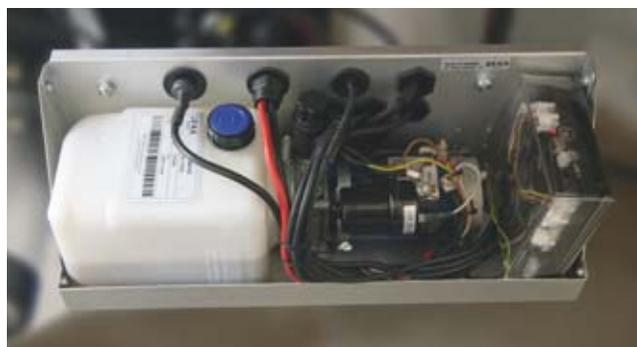
Moteur et commande sont logés de façon bien accessible dans le **boîtier de groupe**. Moteur avec commutateur thermo rupteur protégé contre la surchauffe et l'incendie du moteur. **Commande de secours** simple des quatre fonctions de base par boutons (série BC 750 S2).
