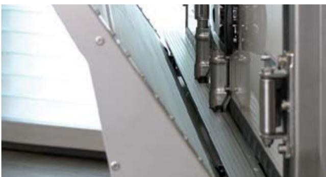
Bär **CargoBridge** (option) pour une connexion de la plateforme derrière les portes de caissons avec twist lock. Économise un becquet du côté caisse.
