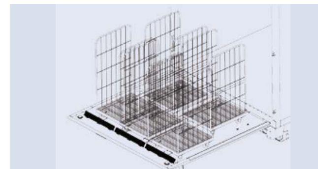
Bloqueur de roll 5Rx pour 5 rolls conteneurs. Largeur de plateforme d'au moins 2440 mm, uniquement en relation avec le système de plateforme AFplan40D.
