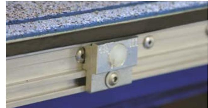
Kofferdichtung Bär **CargoSeal** in Piek-Version (Option) dämpft den Anschlag der Plattform am Aufbau beim Schließen. Mit Gummipuffer als Hubschwingeranschlag beim Heben.
