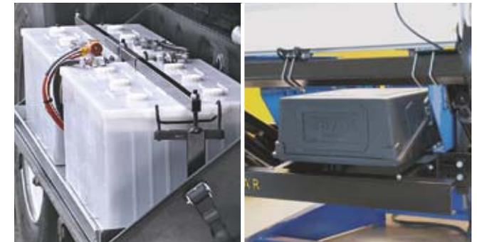
Zuverlässige Stromversorgung mit dem Bär **Batteriekasten** (Option) – kompakt auf Unterfahrerschutz montiert. Ebenfalls als Bär **BatteryBox** (Option) zur seitlichen Montage unter dem Aufbau verfügbar.
