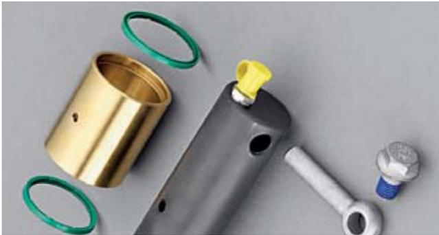
Nachschmierbare, **wartungsarme Lager** (Serie). Schmierintervall halbjährlich bei Zweischichtbetrieb. Anschluss an Zentralschmieranlage serienmäßig möglich.
