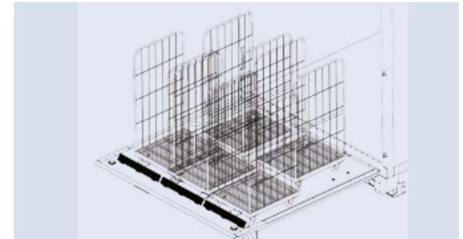
**Abroll sicherung 5Rx** für 5 Rollbehälter. Plattform-Breite mindestens 2440 mm, nur in Verbindung mit Plattformsystem AFplan40D.
