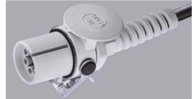
Elektronisch gesteuerte **Ladeleitung SmartCharge SC-VEHH** (Option) als genormte Steckverbindung zum beliebigen Tausch von Zugfahrzeug und Anhänger. Intelligente Steuerung sichert ausreichende Batteriespannung an der Abladestelle. Anzeige von Störungen per Blinksignal.
