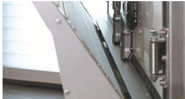
Bär **CargoBridge** (Option – außer BC 1000 / 3000 S4) für Anbau der Plattform hinter Koffertüren mit Drehstangenverschlüssen. Erspart aufbauseitige Überfahrnase.
