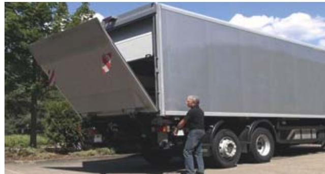
Bär **SmartControl Rolltorsteuerung** (Option) öffnet und schließt das Rolltor des Aufbaus automatisch in Abhängigkeit von der Cargolift-Bedienung, damit die Kälte im Aufbau bleibt und die Bedienung erleichtert wird.
