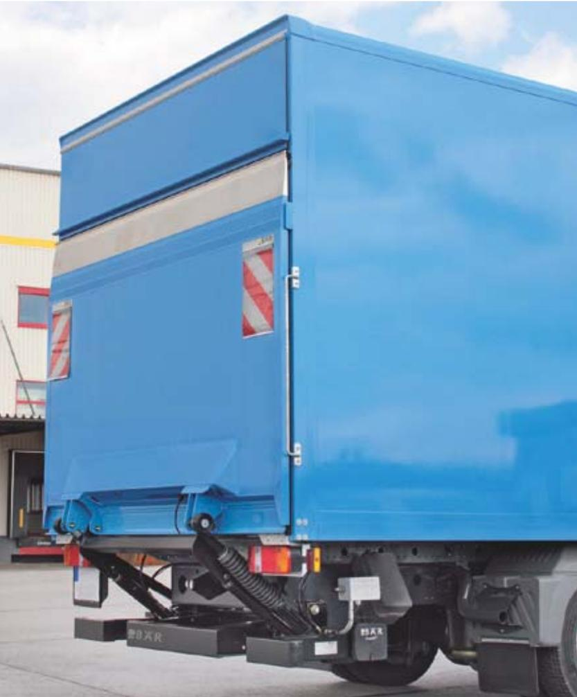
Nur 360 kg bei einer Plattformhöhe von 1810 mm und einem Lastmoment von 9,0 kNm! Der BC 1500 S4L bietet eine gewichtsgünstige Lösung mit vier Zylindern, wenn der Unterfahrerschutz nicht mitschwenken darf oder wenn hohe Betriebsgeschwindigkeit gefragt ist. Mit den bewährten S4-Ausstattungs-vorteilen und einem „abgespeckten“ Lastmoment bietet Ihnen dieser Cargolift mit Hochdruck mehr Effizienz in Ihrer Logistikkette.
