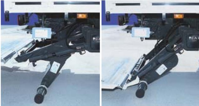
**Mechanischer Unterfahrerschutz** für BC 2000 S4U (Serie). Wird zum Abklappen bei Lkw-Solo-Fahrbetrieb oder bei Nutzung der Normalkupplung beim Hochfahren mit dem Fuß am Boden festgehalten.
