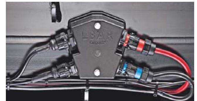
**Elektrische Schnittstelle VDHH** (Serie) für den einfachen elektrischen Anschluss. Elektrische Anschlüsse in Fahrbahnnähe werden mit **Abdeckblech** (Option) am Tragrohr geschützt.
