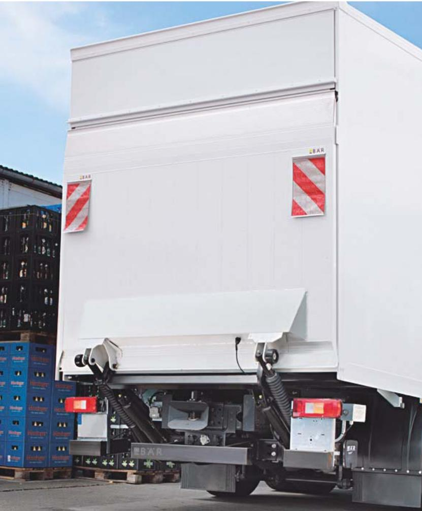
Montagen an Drehschemel-Anhänger lassen meist wenig Platz für eine Hubladebühne – deshalb benötigt der BC 2000 S4A nur den kurzen Freiraum von 580 mm am Fahrzeugheck. Bei gleichzeitig hohem Lastmoment und umfangreicher Ausstattungsvielfalt.
