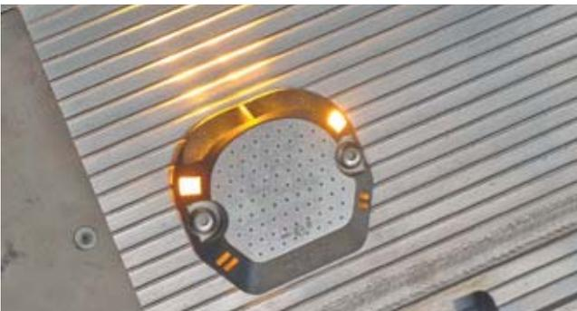
Robuste LED-Blinkleuchte **CargoFlash** (Serie) mit großer Lichtstärke und sehr guter seitlicher Abstrahlung bei geringer Stromaufnahme. **Schutzwinkel** für Blinkleuchten (Option) sind verfügbar.
