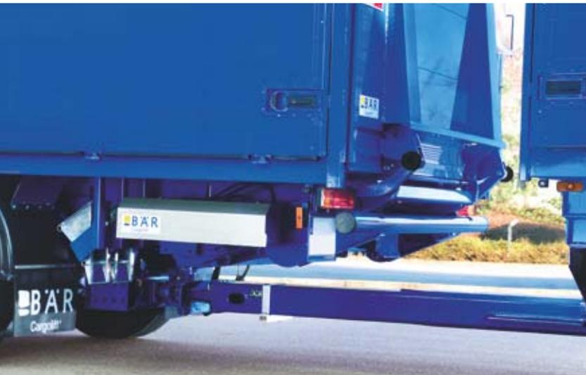
Kombinierte Normal- und Tiefkupplung und zusätzlich eine Hubladebühne? Der BC 2000 S4U macht's möglich, denn alle Bauteile gewährleisten eine Deichselfreiheit von 180°/6°. Der serienmäßige, mechanische Unterfahrschutz (UFS) wird bei Anhängerbetrieb einfach oben positioniert – im Solo-Betrieb bequem mit dem Fuß am Boden gehalten. Komfortabler wird die Bedienung mit dem optionalen, hydraulischen Unterfahrschutz.
