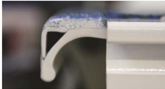
Die Plattformen von Standard Cargolifts haben eine Rundung zum Aufbau hin, um das Schließen zu ermöglichen. An dieser Stelle entsteht ein „Schlagloch“ beim Überfahren, weshalb S4 Cargolifts in Piek-Version ein **Anschlussprofil** erhalten.
