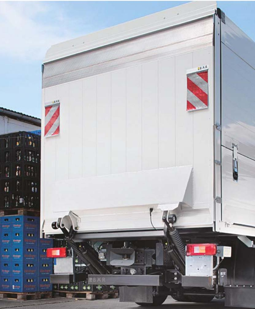
Wenn 2.000 kg Tragkraft für den Transport von Paletten mit Elektrohubwagen nicht mehr ausreichen, bietet der BC 2500 S4 eine naheliegende Alternative: 2.500 kg Tragkraft bei 1.000 mm Lastabstand. Zusammen mit der bis zu 3010 mm hohen Plattform ist dieser Cargolift vor allem in der Getränkelogistik beliebt.
