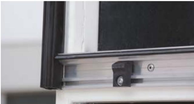
Dichtsystem **CargoSeal** (Option) für zuverlässig dichten Heckabschluss bei aufbauverschließender Plattform.
