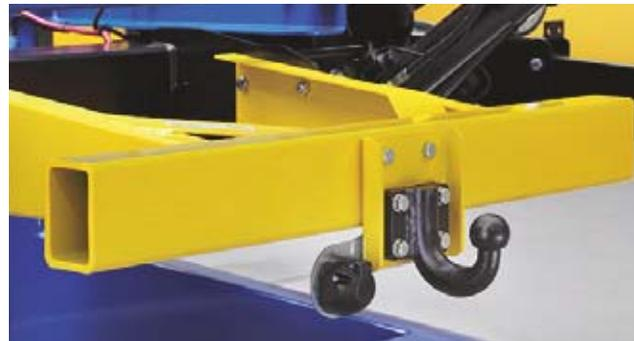
**Anhängebock für Kugelkopfkupplung** (Option) mit Europäischer Teile-Betriebserlaubnis (Teile-ABE). **Kupplungskugel** optional erhältlich.
