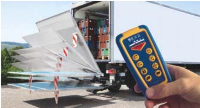
Bär **SmartControl Fernbedienung** (Option) – Die zeitgemäße Cargolift-Bedienung per innovativer Funkfernbedienung. Mit **RadioKey** (Option) erfolgt eine automatische Sperrung gegen unbefugte Nutzung durch Bereichserkennung.
